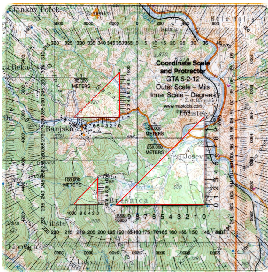
Сл. 50 - GTA 5-2-12 војни координатомер и угломер
